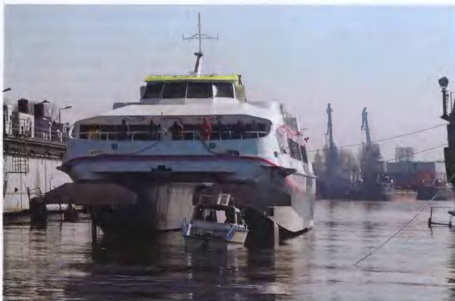
САМЫЙ БЫСТРЫЙ В МИРЕ ПАРОМ Гибридное судно с передним подводным крылом Superfoil 40, построенное "Морским заводом Алмаз", имеет крейсерскую скорость более 100 км/ч
