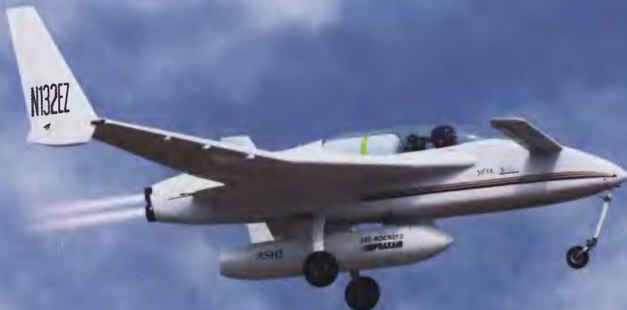
На фотографии самолет модели EZ-Rocket, способный развивать скорость 360 км/ч. Ему на смену пришел Mark-1, построенный специально для гонок на кубок X Prize
