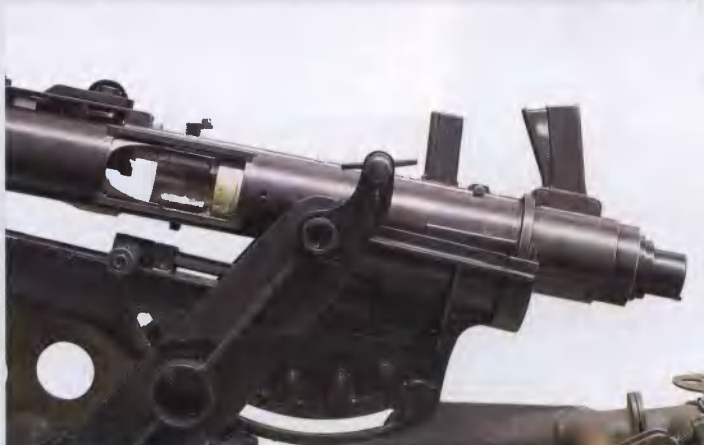
■ Вид слева со взведенным затвором. В открытое окно ствольной коробки вкладывался первый выстрел при зарядании оружия. Снизу видна рукоятка взведения затвора
