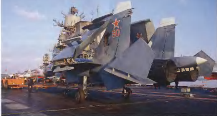
У палубного Су-27К складываются не только крылья, но и горизонтальное оперение
