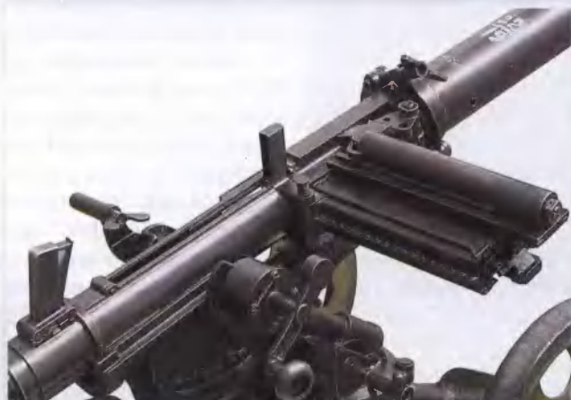
■ Превосходно виден причудливый механизм магазина на пять гранат. Существовало несколько модификаций гранатомета Таубина, в том числе и с ленточным питанием
